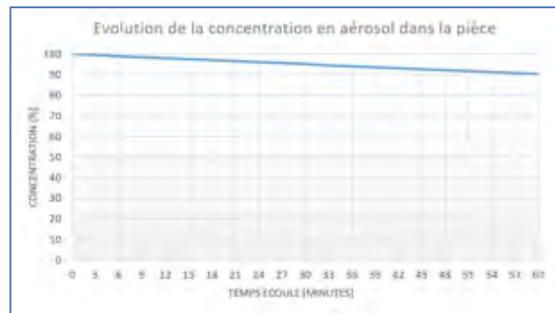
Figure 4 : Evolution de la concentration dans la même pièce, sans VMC, fenêtre fermée
